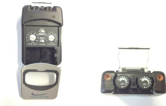
Achten Sie darauf, die Verpackung von der 9V-Batterie zu entfernen. Kontrollieren Sie die Plus-und das Minuspol des Batterie-Anschluss. Stellen Sie sicher, dass beide „IntensityControl“ (ON / OFF-Schalter) Knöpfe in der Aus-Stellung geschaltet sind.
